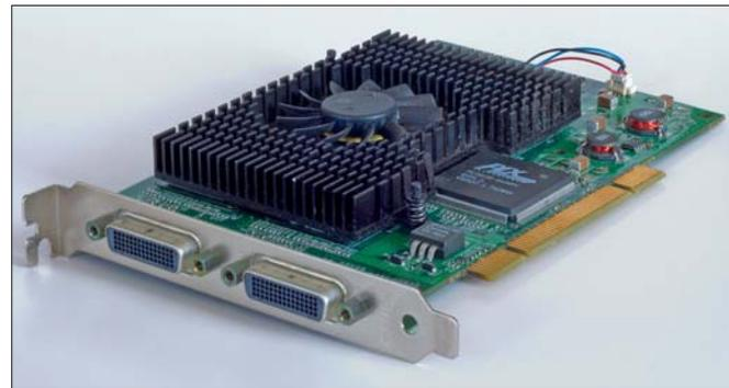
Des Autors Liebling – eine Matrox G450 x 4MMS für den PCI-Steckplatz mit Anschlüssen für vier analoge oder digitale Monitore bis zu einer maximalen Auflösung von 1600 x 1440 Pixel. Gebraucht kann man sie für rund € 40,- bis 60,- bekommen. Die Monitore werden mit einem proprietären Y-Kabel angeschlossen, daher sollte beim Erwerb auf das Vorhandensein beider Kabel geachtet werden. Analoge Monitore können per Adapter betrieben werden.
