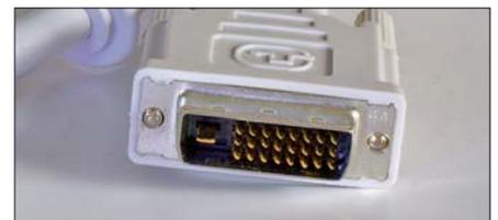
Diverse Buchsen und Stecker sorgen für die Verbindung zwischen Grafikkarte und Monitor im PC-Bereich: Oben eine 15-polige VGA-Buchse – „ganz früher“ gab es diese Buchse auch in 9-poliger Ausführung, DVI-D „single link“ (mitte oben) und DVI-D „dual link“ (oben rechts), HDMI (unten links) und BNC (unten rechts).
