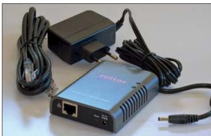
Externe Grafikkarten zum Betrieb per Netzwerk (oben) oder USB (unten) erlauben eine einfache Erweiterung des PCs zum Anschluss weiterer Monitore. Zu favorisieren ist ein Modell mit DVI-Ausgang, bei Bedarf möglichst gleich mit VGA-Adapter. Je nach geplantem oder vorhandenem Monitor sollte darauf geachtet werden, dass die Grafikkarte die benötigte Bildschirmauflösung liefern kann.
