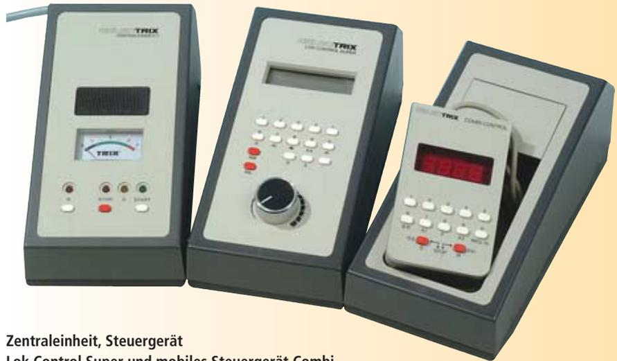
Zentraleinheit, Steuergerät Lok Control Super und mobiles Steuergerät Combi Control aus dem frühen Trix-Selectrix-Sortiment. Foto: gp
