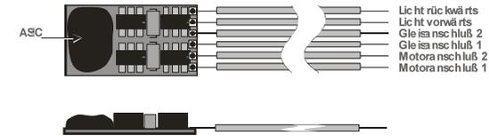
Der **SLX831** wird mit hochflexiblen farbigen Litzen in 11cm Länge geliefert.
