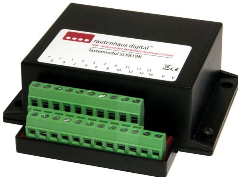
Tastermodul mit updatefähigem Prozessor, RMX7-, RMX1-, SX0 sowie SX1 kompatiblen 7-poligen Busanschlussbuchsen.
