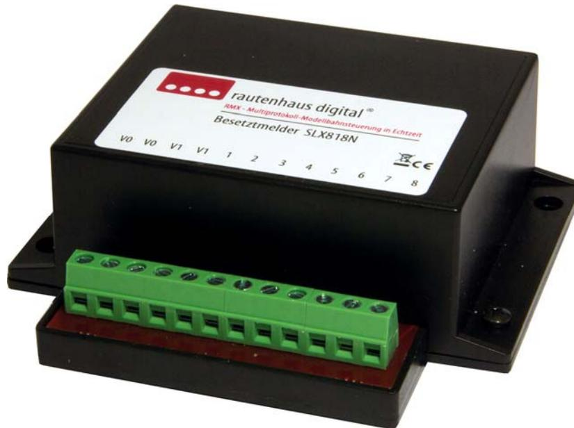
Neuer überarbeiteter Besetzmelder mit updatefähigen Prozessor, RMX7-, RMX1-, SX0 sowie SX1 kompatibler 7-poligen Busanschlussbuchsen und verstärkter Ausgangsbelastbarkeit bis 4A. Besetzmelder zum Überwachen und Melden von bis zu 8 Gleisabschnitten.
