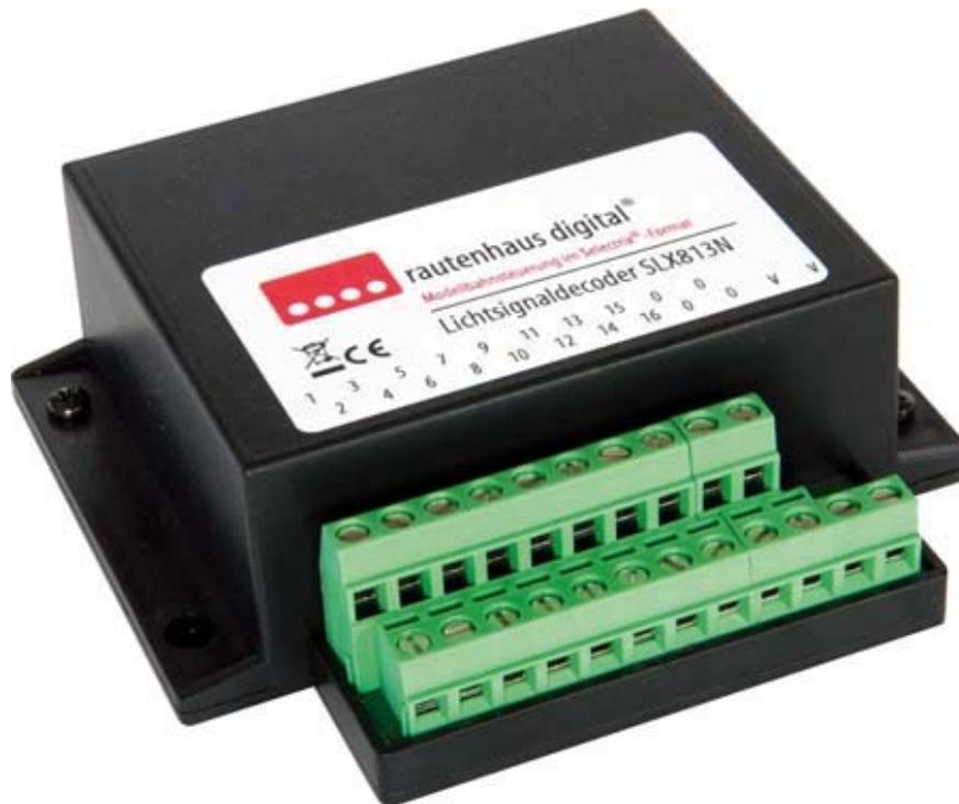
Der Lichtsignaldecoder SLX813N erlaubt den einfachen Anschluss und komfortablen Betrieb von Lichtsignalen am rautenhaus digital®-System. Der SLX813N steuert bis zu 16 Glühlampen oder LEDs (mit Vorwiderstand) oder vordefinierte Signaltypen ("Begriffe") an und unterstützt dabei sowohl eine kurzzeitige Dunkeltastung der Signallampen, die beim Vorbild zur Vermeidung ungültiger Signalbegriffe verwendet wird, als auch ein Auf- und Abdimmen der Signallampen beim Wechsel des Signalbildes.
