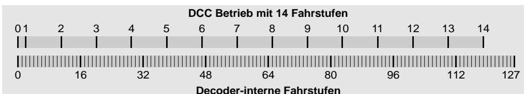
Für den Betrieb mit 14 bzw. 28 DCC-Fahrstufen kann eine Mindestgeschwindigkeit festgelegt werden. Das ist die kleinste interne Dauer-Fahrstufe, die bei DCC-Fahrstufe 1 eingenommen wird (Werkseinstellung 2). Beim Beschleunigen aus
