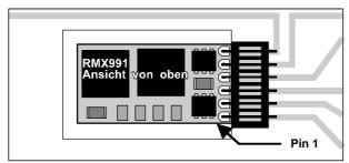
Beachten Sie bitte, dass die Anschlussdrähte gerade in die jeweiligen Kontakte eingeführt werden und keine Verbindung zu anderen Leiterbahnen entstehen.
