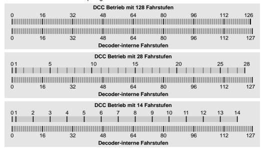
Für den Betrieb mit 14 bzw. 28 DCC-Fahrstufen kann eine Mindestgeschwindigkeit festgelegt werden. Das ist die kleinste interne Dauer-Fahrstufe, die bei DCC-Fahrstufe 1 eingenommen wird (Werkseinstellung 2). Beim Beschleunigen aus dem Stillstand wird auch hier über die interne Fahrstufe 1 bis zu dieser Mindestgeschwindigkeit mit Massensimulation hochgeschaltet; entsprechend auch beim Bremsen.
