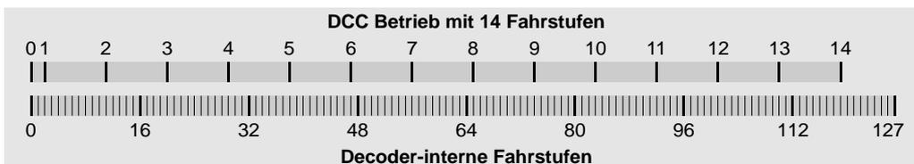
Für den Betrieb mit 14 bzw. 28 DCC-Fahrstufen kann eine Mindestgeschwindigkeit festgelegt werden. Das ist die kleinste interne Dauer-Fahrstufe, die bei DCC-Fahrstufe 1 eingenommen wird (Werkseinstellung 2). Beim Beschleunigen aus dem Stillstand wird auch hier über die interne Fahrstufe 1 bis zu dieser Mindestgeschwindigkeit mit Massensimulation hochgeschaltet; entsprechend auch beim Bremsen.
