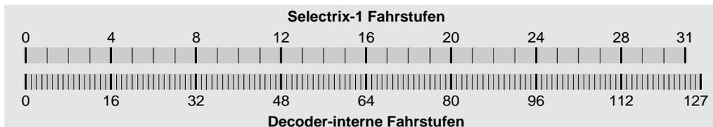
**SelectRIX-2:** Der Decoder unterstützt bei SX2-Betrieb normalerweise 127 Fahrregler-Fahrstufen, die direkt als interne Fahrstufen verwendet werden (Parameter 003 = 112). Dieser Decoder unterstützt auch eine Variante des SX2-Betriebes, mit der nur 31 Fahrstufen des Fahrreglers ausgenutzt werden (Parameter 003 = 000). Die 31 Fahrregler-Fahrstufen werden hierbei, analog zu SelectRIX-1 Betrieb, in die internen 127 Fahrstufen umgesetzt.
