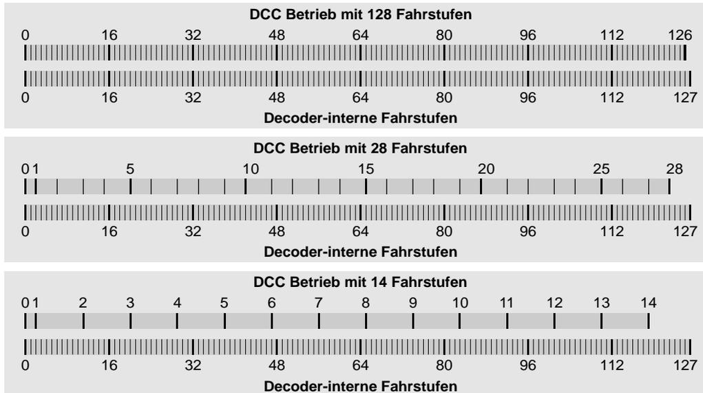
Für den Betrieb mit 14 bzw. 28 DCC-Fahrstufen kann eine Mindestgeschwindigkeit festgelegt werden. Das ist die kleinste interne Dauer-Fahrstufe, die bei DCC-Fahrstufe 1 eingenommen wird (Werkseinstellung 2). Beim Beschleunigen aus dem Stillstand wird auch hier über die interne Fahrstufe 1 bis zu dieser Mindestgeschwindigkeit mit Massensimulation hochgeschaltet; entsprechend auch beim Bremsen.
