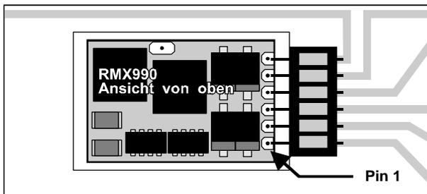
Beachten Sie bitte, dass die Anschlussdrähte gerade in die jeweiligen Kontakte eingeführt werden und keine Verbindung zu anderen Leiterbahnen entstehen.
