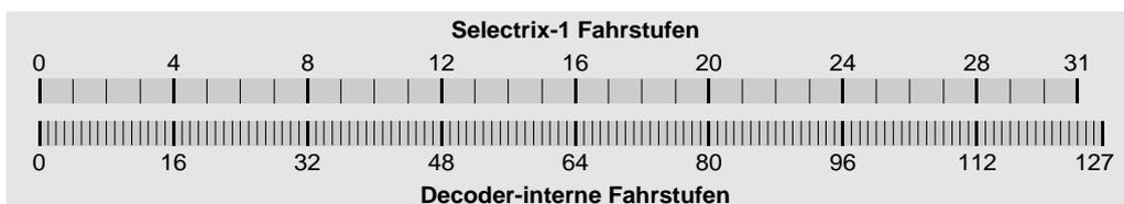
**SelectRIX-2:** Der Decoder unterstützt bei SX2-Betrieb normalerweise 127 Fahrregler-Fahrstufen, die direkt als interne Fahrstufen verwendet werden (Parameter 003 = 112).
